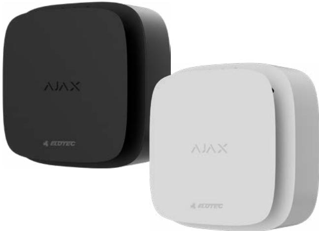
Detektoren har to temperaturfølere som reagerer på økt temperatur. Om temperaturen i rommet går over 64°C eller økes med mer enn 10°C i løpet av ett minutt vil detektoren gå i alarm basert på den raske temperaturstigningen.
